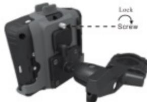
**3. закрепите кронштейн крепления на руле мотоцикла** вудобном
